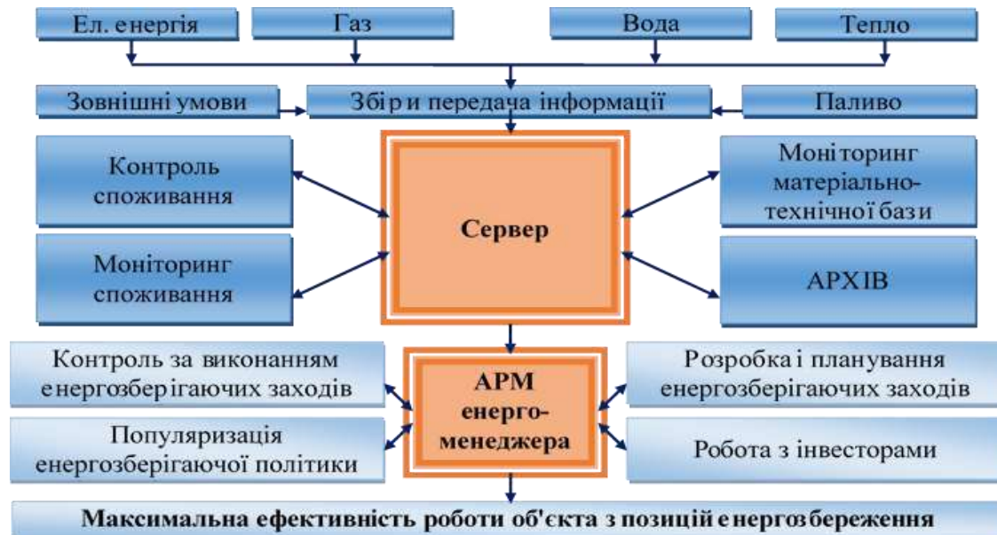
Рисунок 1. Автоматизоване робоче місце (АРМ) енергоменеджера
